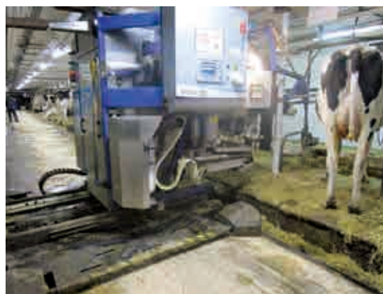
▲▼MilkoMax社製タイストール式自動搾乳ロボット 『ROBOLEO』
